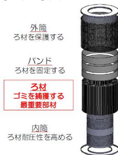
【図表5】建機用フィルタの構造
