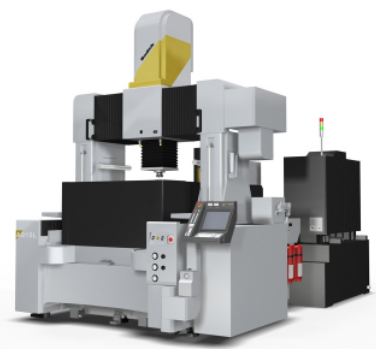
図表 4 放電加工機の基本原理と電極、被工作物のサンプル、加工機本体
